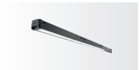
HB INFINITY 56 Iluminación de acento o ambiental Luminaria interconectable de alto flujo luminoso, hasta 125 luminarias en una línea continua. Ópticas 40°x110°, 60°x110° y 90°. Variedad de colores disponibles y atenuable mediante varios protocolos de control.
