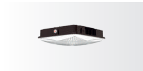
CANOPY CCT 179 Iluminación general o ambiental Óptica tipo V. Atenuable 0-10 V. Flujo luminoso de hasta 15,600 lm.
