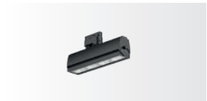
WALLTRACK 130 Efecto wall washer con óptica 30°x60°. IRC 90. Giro de 360° Para lograr una bañado uniforme, basta con montarlos a 1 m de distancia del muro y entre cada luminario.
