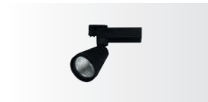
ECUS PRO 140 Iluminación de acento 3200 lm. 3000K. Fuente de luz remetida que ayuda a disminuir el deslumbramiento
