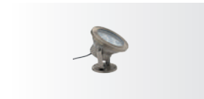
ESCAFANDRA PROYECTOR 211 Luminaria para exteriores IP67. Ópticas a elegir 10°, 30° y asimétrica 10×40°. Luminaria de alto flujo luminoso para iluminar elementos arquitectónicos altos.
